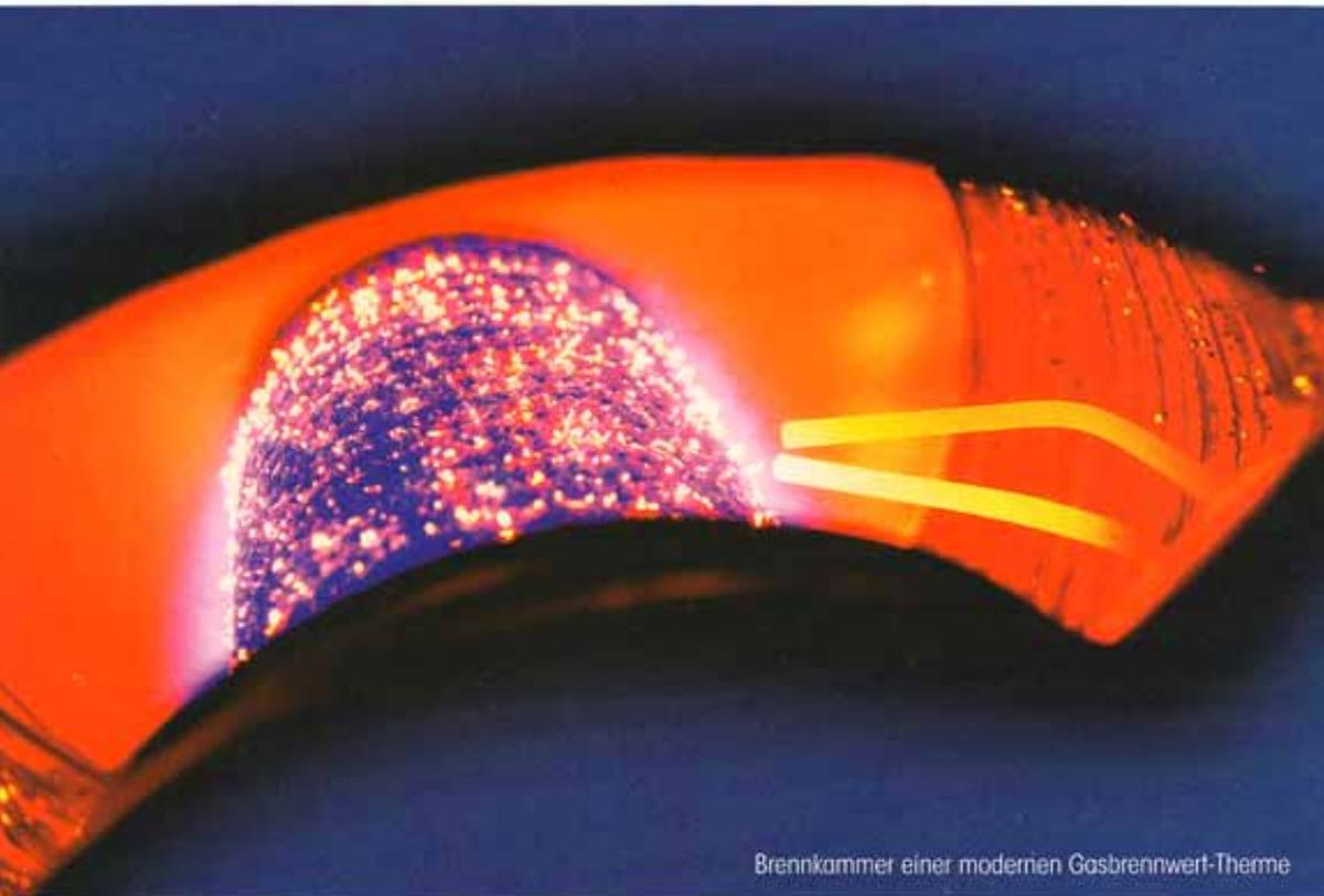
Brennkammer einer modernen Gasbrennwert-therme
